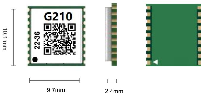
G210D 是一款多星系、并发、双频单点L1+L5定位的 GNSS 模块。内置12纳米先进制程GNSS Soc芯片，集成主频高达530MHz ARM Cortex-M4 FPU and MPU，模块支持 GPS、BeiDou、GLONASS、GALILEO 和QZSS 多卫星系统，具备出色的融合定位性能，同时保持低功耗。
