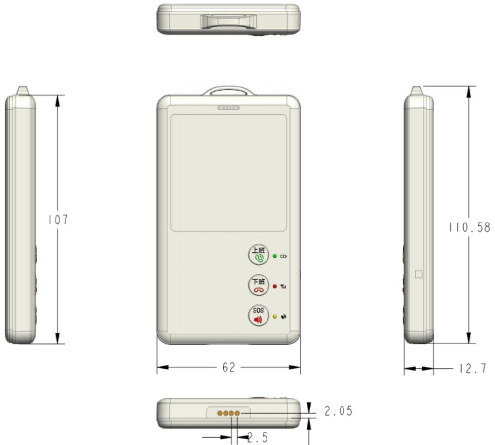
P20 电子工牌底部是磁吸充电, 可每台单独使用磁吸充电线充电, 也可以定制, 充电柜, 实现工地、园区、矿区等集中充电。
